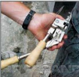
5-Passe a fita pelos canais da faca e do eixo e encoste o aparelho no selo ou fecho.
